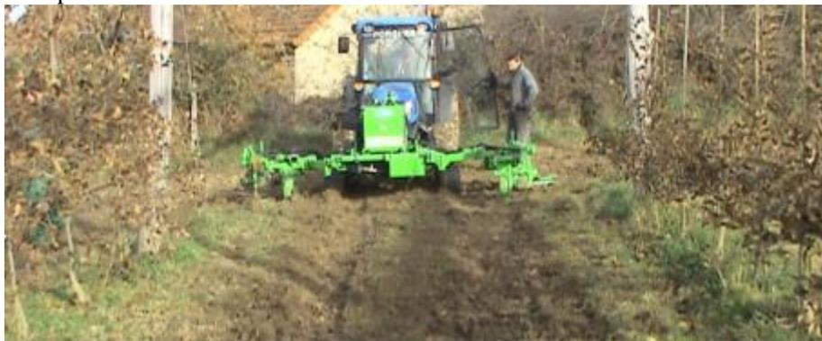
Photo 3 : Châssis avec le double porte-outil
